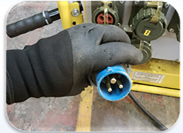
Paso 3 Acercar enchufe macho del carrete o foco.
