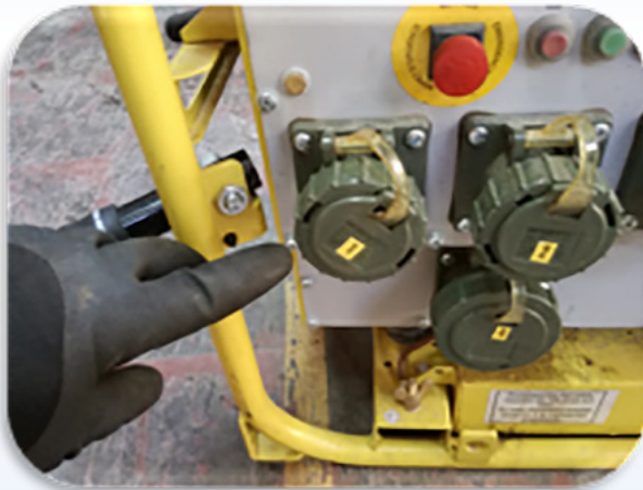
Paso 1 Ubicar una de las salidas de 220 v del generador.
