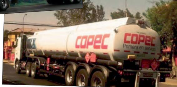
Otra forma de reconocer materiales peligrosos es por los envases, los cuales pueden ser portátiles o especialmente diseñados para vehículos.
