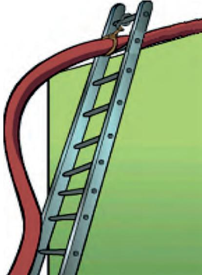
Una forma práctica y simple de afirmar las mangueras a las escalas es mediante las “amarras”, consistente en un gancho metálico sencillo con un cordin o cuerda corta. Esta permite afirmar la manguera sin estrangularla y sin afectar el caudal.
