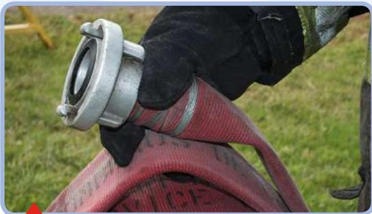
**Despliegue:** tomar con una mano unión con dos dedos y con los otros tres dedos sujetar la manguera. Balancear y lanzar.
