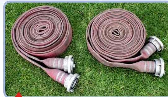
**Despliegue:** unir la unión interior de una manguera con la exterior de otra. La manguera que quedo con la unión al exterior, se debe desplegar en su totalidad.
