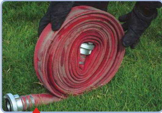
Se enrolla con una unión dentro y otra afuera.
