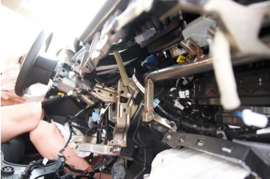
Figura N° 15. Barra de refuerzo transversal (vista derecha).
