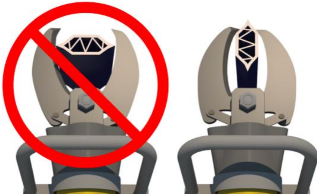
Figura N° 45. Cizalla (como forma recomendada de corte envolvente puede ocuparse sobre una sección transversal cuando sea imposible aplicar la herramienta a una sección longitudinal).
