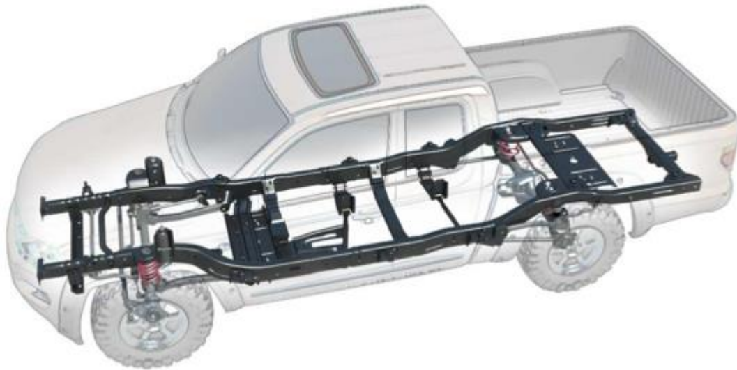
Figura N° 11. Construcción con chasis. Carrocería montada sobre dos vigas paralelas que dan soporte a la estructura.
