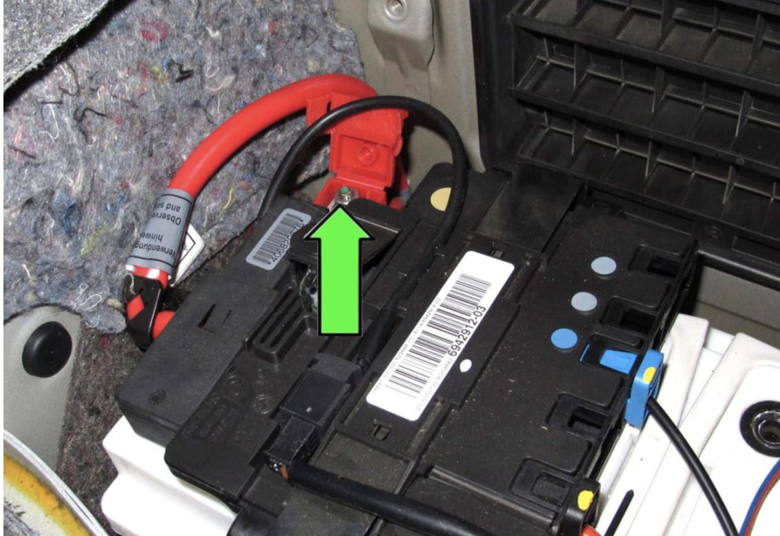
Figura N° 36. BATERÍA BMW E90, que cuenta con actuador pirotécnico para la desconexión automática del borne positivo.
