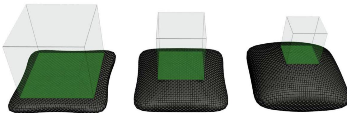
Figura N° 48. Cojines de levantamiento (pierden superficie de contacto en la medida que aumenta su volumen).
