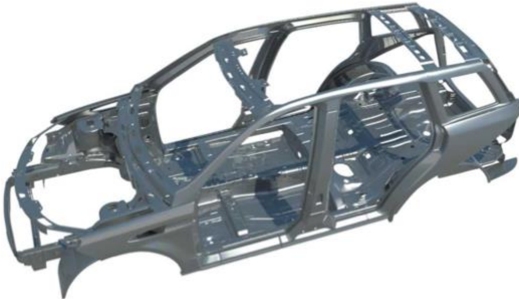
Figura N° 12. Carrocería integrada tipo monocasco con estructura completa de una sola pieza que da soporte y forma al vehículo.
