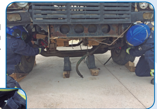
Estabilización vertical suelo-chasis en un vehículo pesado.
