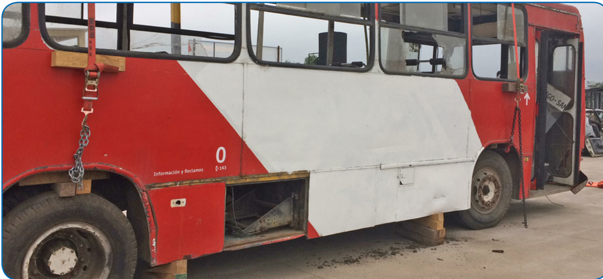
Bloqueo de suspensión con cinta ratchet.
