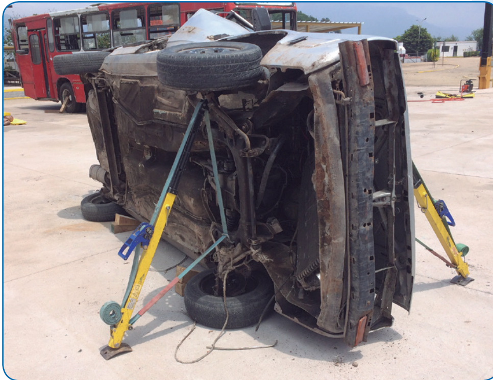
Estabilización secundaria con dos (2) estabilizadores de vehículo volcado sobre su costado (visión trasera).
