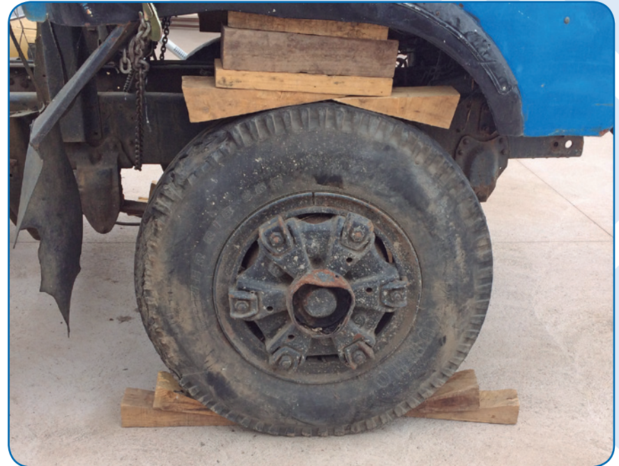
Estabilización primaria horizontal en vehículo mayor utilizando dos (2) cuñas biseladas.
