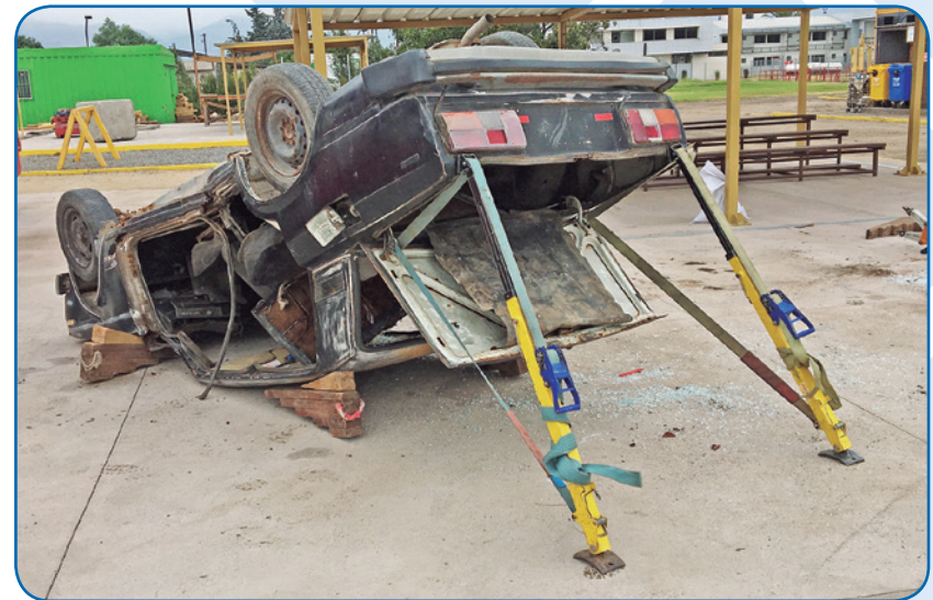
Estabilización secundaria por medio de estabilizadores longitudinales al vehículo volcado sobre su techo.
