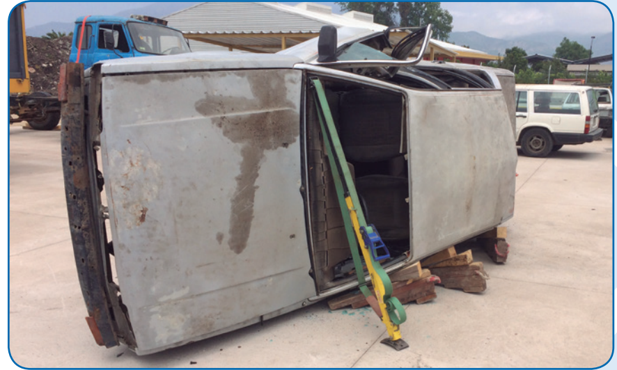
Estabilización secundaria con un (1) estabilizador de vehículo volcado sobre su costado (visión delantera).
