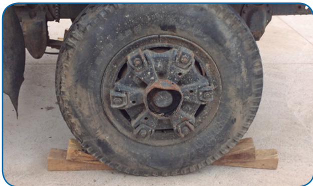
Estabilización horizontal mediante dos cuñas biseladas en las ruedas.
