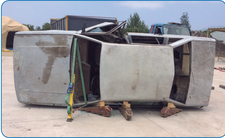
Estabilización secundaria con un (1) estabilizador de un vehículo volcado sobre su costado (visión de techo).
