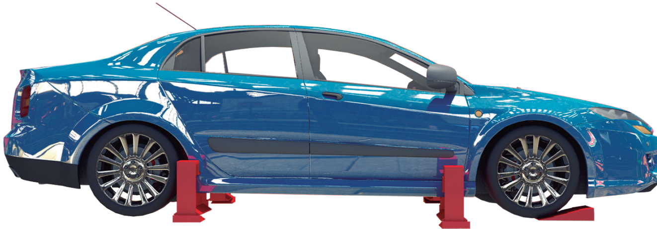
Cuñas escalonadas y biseladas para la estabilización vertical.
