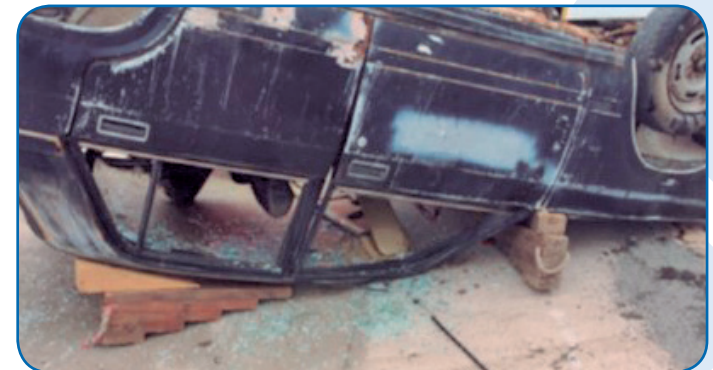
Cuñas instaladas para estabilización primaria en vehículo volcado sobre su propio techo.
