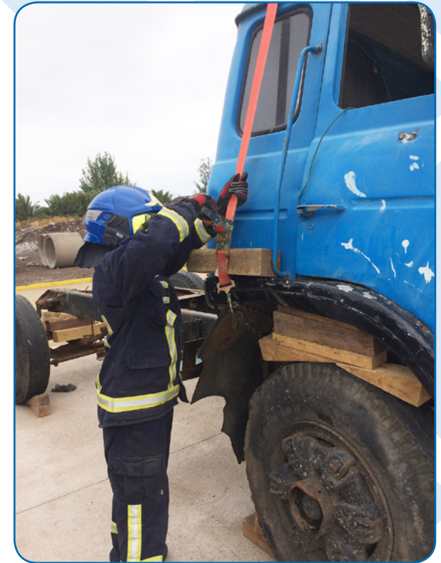
Fijación chasis-cabina con cinta ratchet.
