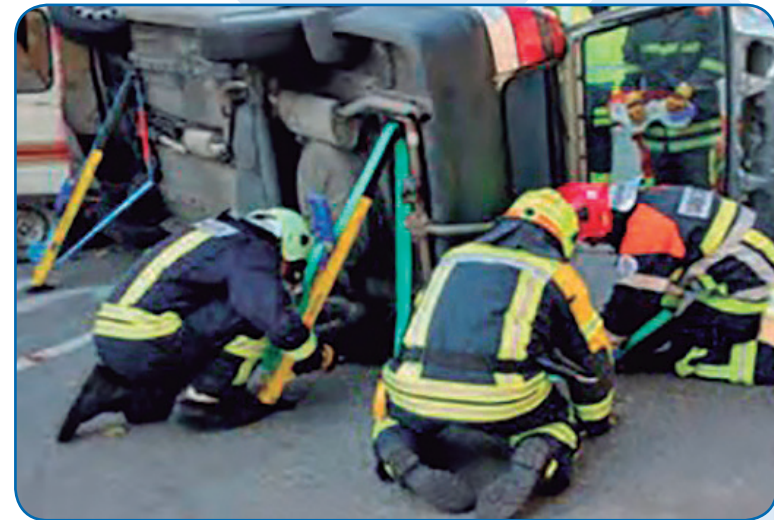
Rescatistas realizando estabilización por el lado sucio de un vehículo volcado sobre su costado.
