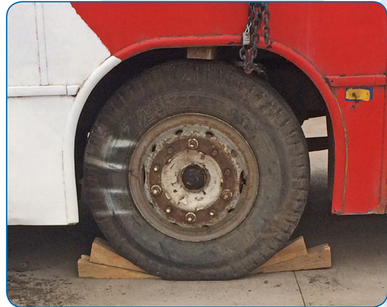
Estabilización primaria horizontal en vehículo pesado utilizando dos cuñas biseladas.
