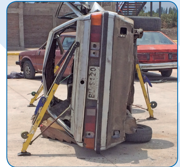
Estabilización primaria y secundaria en vehículo volcado sobre su costado.
