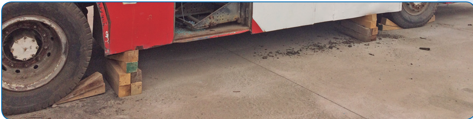
Estabilización primaria en bus.
