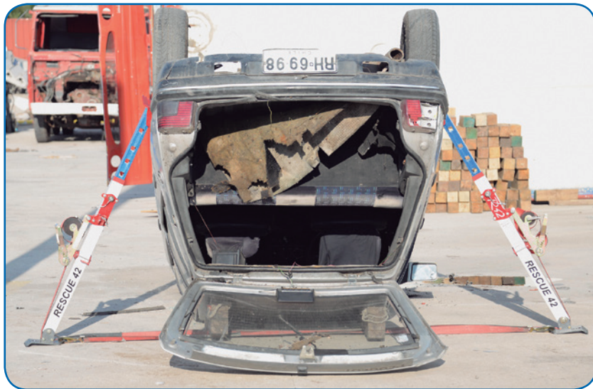
Estabilización secundaria por medio de estabilizadores perpendicular al vehículo volcado sobre su techo.
