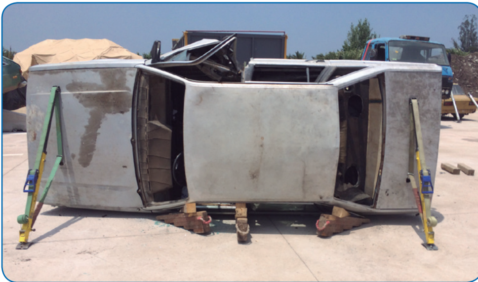
Estabilización secundaria de vehículo volcado sobre su costado completada por lado limpio, con tres estabilizadores.
