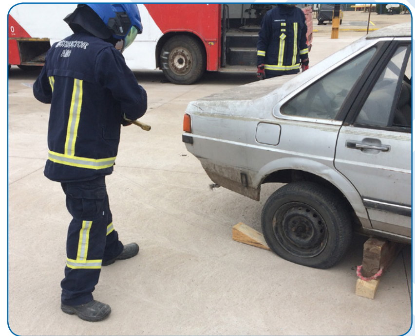
Cuña biselada en la rueda de un vehículo como parte de la estabilización horizontal.
