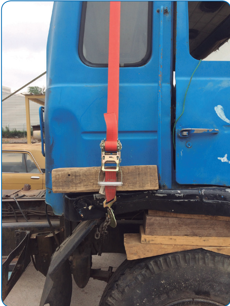
Estabilización vertical de un vehículo pesado. No se debe bloquear la apertura de la puerta.
