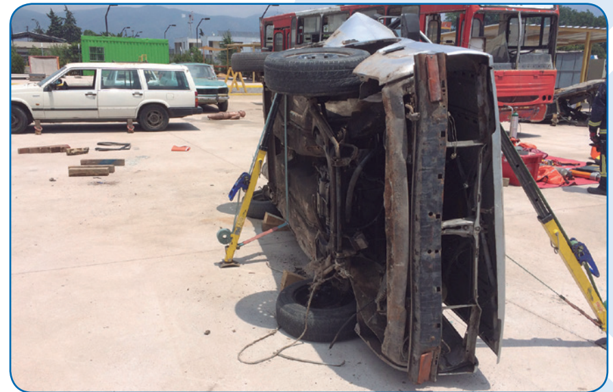
Estabilización secundaria completada, vehículo volcado sobre su costado, con tres (3) estabilizadores (visión delantera).
